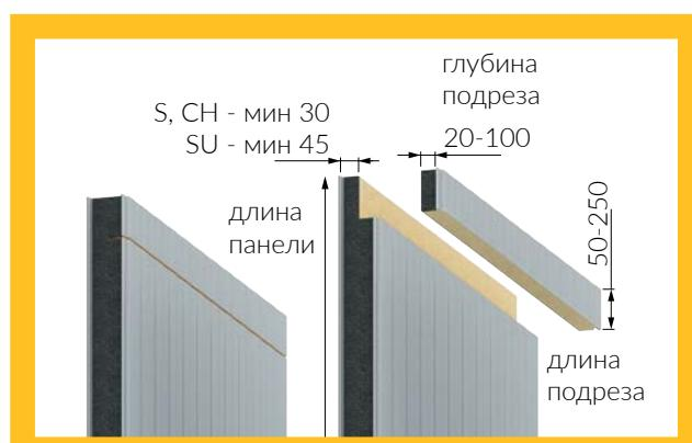
Подрез стенных панелей.
