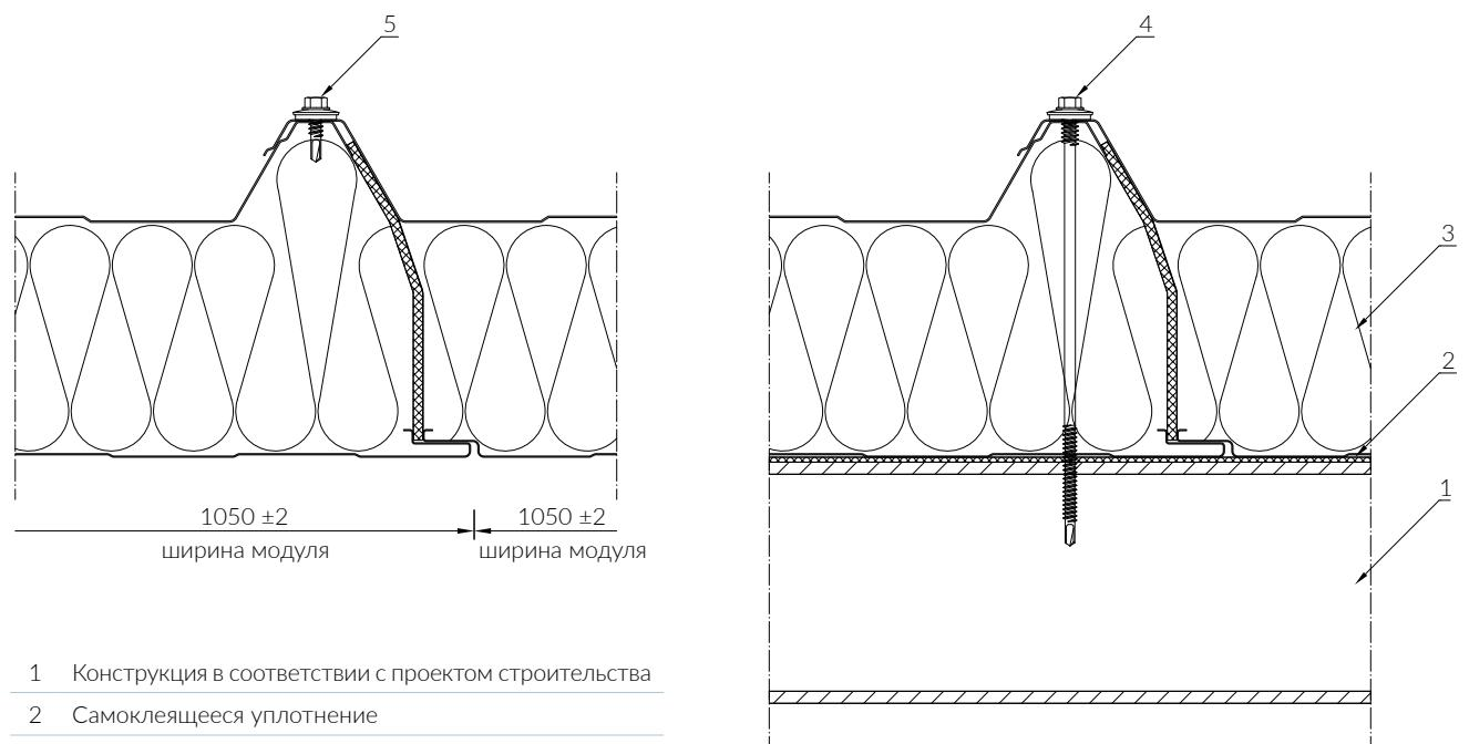
Крепежный соединитель следует подбирать с учетом типа и толщины конструкции (сталь, дерево, железобетон и т. д.) и функции перегородки. Количество крепежных соединителей указано в таблицах нагрузки.
