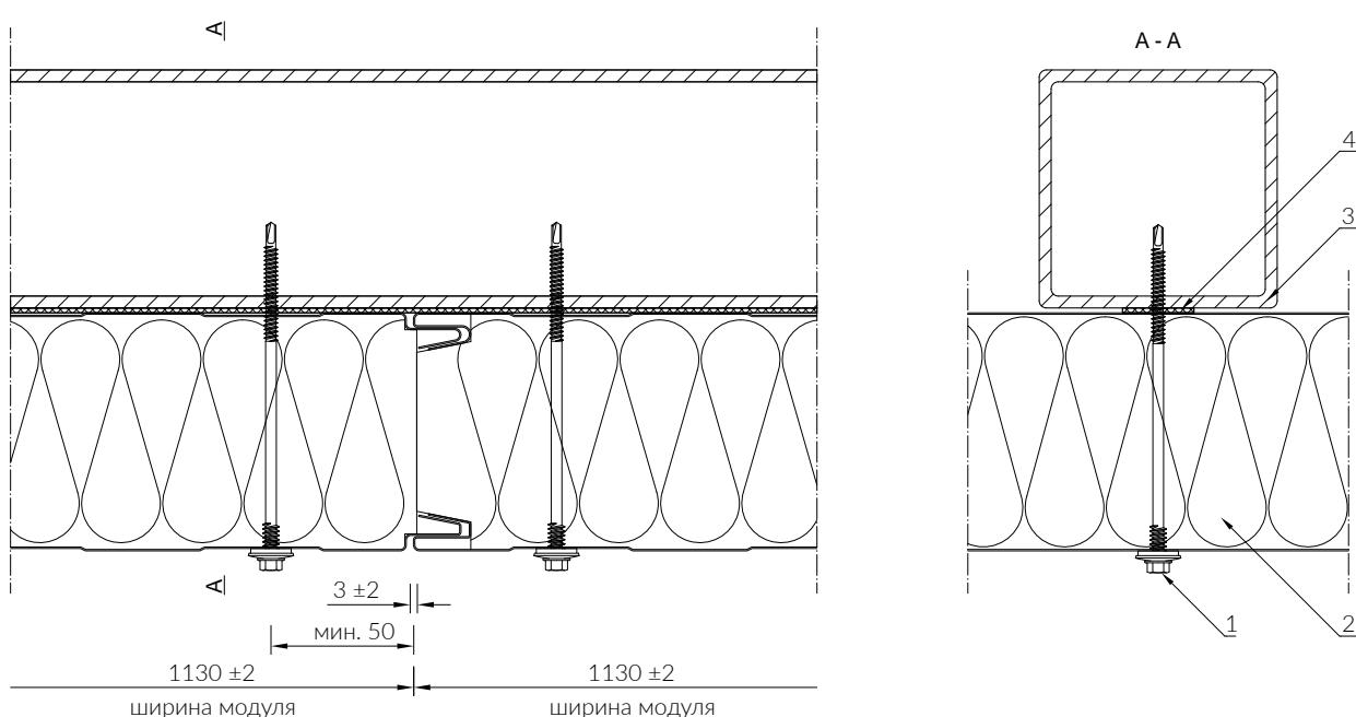
Крепежный соединитель следует подбирать с учетом типа и толщины конструкции (сталь, дерево, железобетон и т. д.) и функции перегородки. Количество крепежных соединителей указано в таблицах нагрузки.
