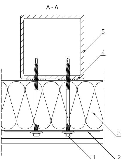
Крепежный соединитель следует подбирать с учетом типа и толщины конструкции (сталь, дерево, железобетон и т. д.) и функции перегородки.
